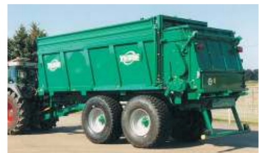
HS 220 with 1400-mm steel sides and 600-mm extensions giving a level loaded capacity of 25 m 3 . The tyres are 650/65 R 30,5 Michelin Cargo X BIB tyres. Le HS 220 avec des côtés de 1400 mm et une rehausse de 600 mm. Volume de chargement de 25 m 3 . Pneus 650/65 R 30,5 Michelin Cargo X BIB.
